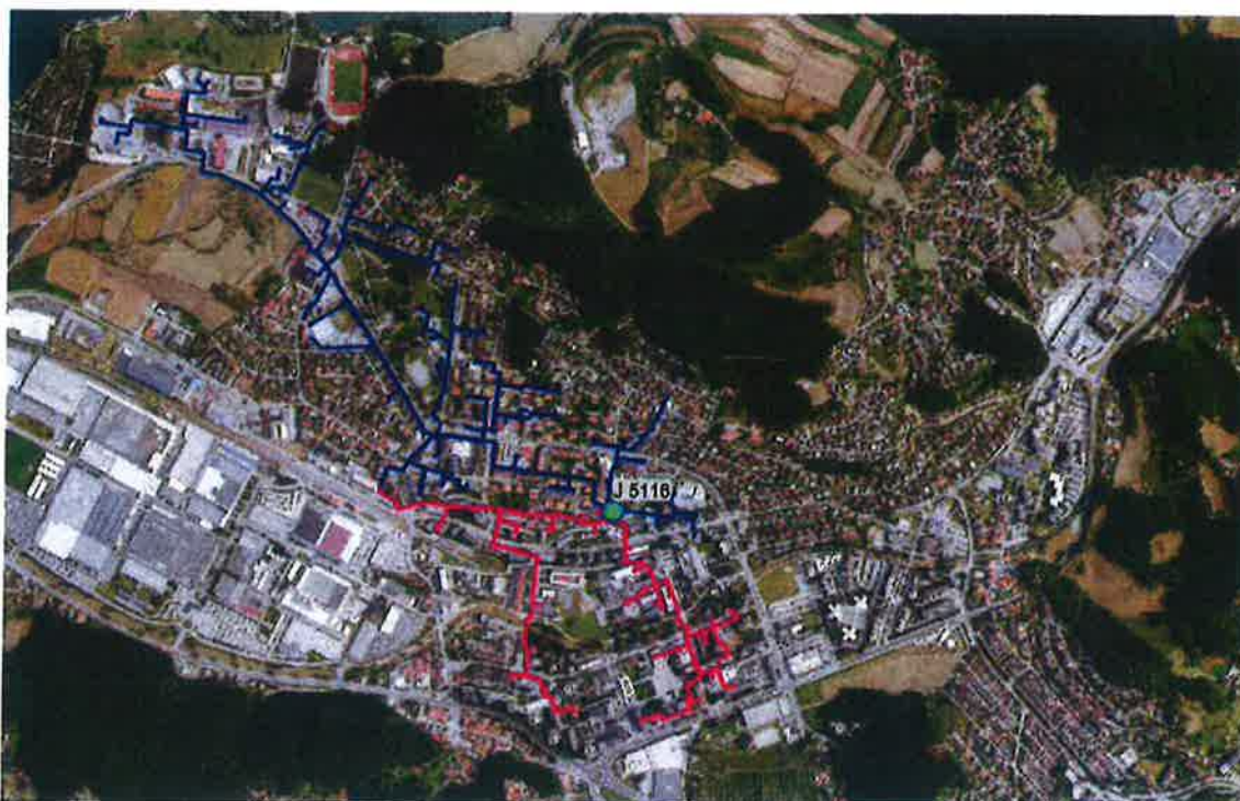
Slika 1: Primarno distribucijsko omrežje CEP 120/70°C - Severna veja in veja FT 13
