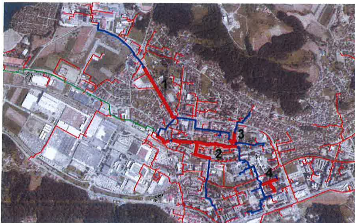
Slika 2: 4 odseki toplovodnega CEP omrežja, ki so predmet obnove; cca 1.700 m
